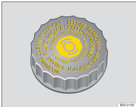
图 113 发动机舱内：制动液容器的盖子。
