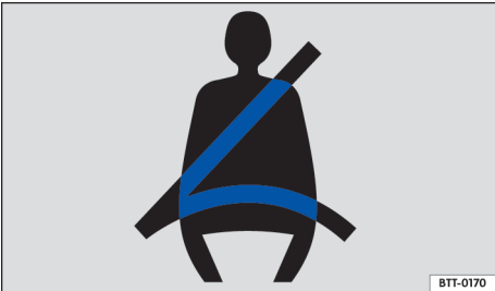
图 58 安全带未系警告灯
