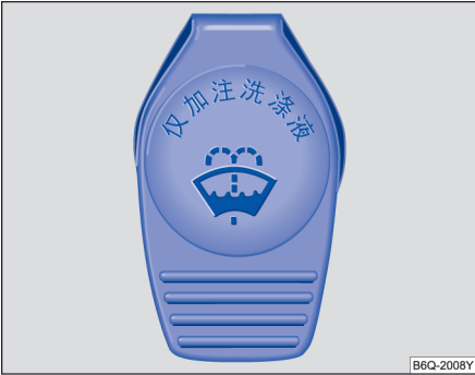
图 86 发动机舱内：风窗清洗液容器盖。
