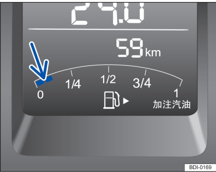
图 131 组合仪表局部视图：燃油存量表
